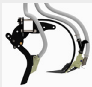
Przednia redlica nawozowa (umieszczenie pod nasionami)
